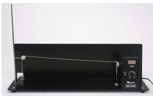
Figura 2 – Montagem experimental para estudar a relação entre frequência e comprimento de onda.
