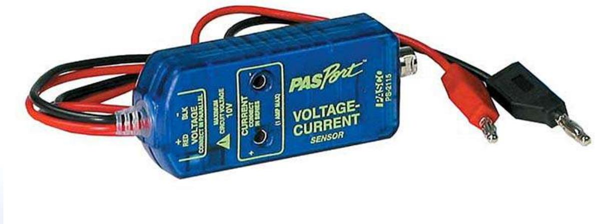
Utilizados na aquisição de medições de tensão ou corrente em função do tempo (sensor de tensão-corrente).
