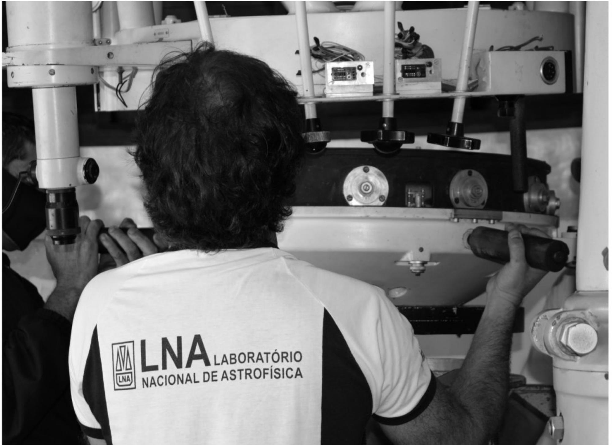
**Equipe do Laboratório Nacional de Astrofísica (LNA) durante a operação de retirada do espelho principal do telescópio da Serra da Piedade. Vista da bacia que abriga o espelho, antes de ser levado para o processo de realuminização, na sede do LNA, para recuperar a sua refletividade.**
