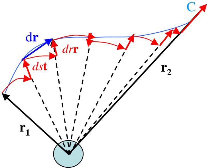
O deslocamento  $d\mathbf{r}$  ao longo da curva  $C$  pode ser decomposto em um deslocamento angular,  $dst$  (perpendicular a  $\mathbf{r}$ ), e um deslocamento radial,  $drr$  (paralelo a  $\mathbf{r}$ ):
