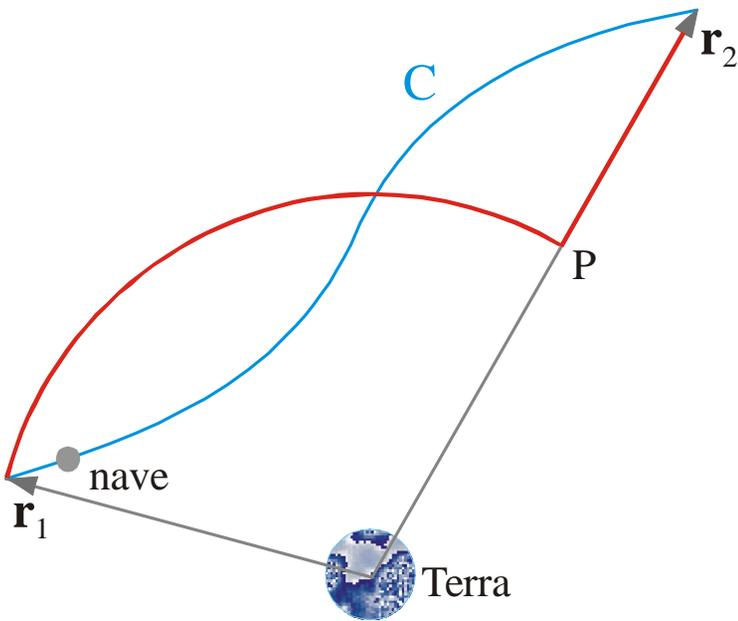
A Figura acima mostra a nave indo do ponto  $r_1$  ao ponto  $r_2$  por uma trajetória na qual fica evidente que o trabalho realizado pela Terra somente depende dos valores de  $r_1$  e  $r_2$ .
