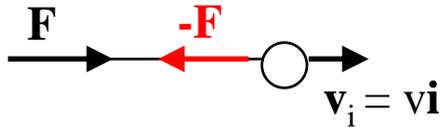
O objeto em movimento é freado por um dispositivo através de uma força  $-\mathbf{F}$ .
