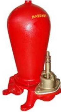
Figura 2: Fotografia de um carneiro hidráulico comercial. Sobressai-se a “garrafa” para compressão do ar que, neste modelo, possui aproximadamente 40 cm de altura. À direita, ressalta-se a válvula de desperdício (veja um equipamento semelhante a este, em operação, no filme em [5]).
